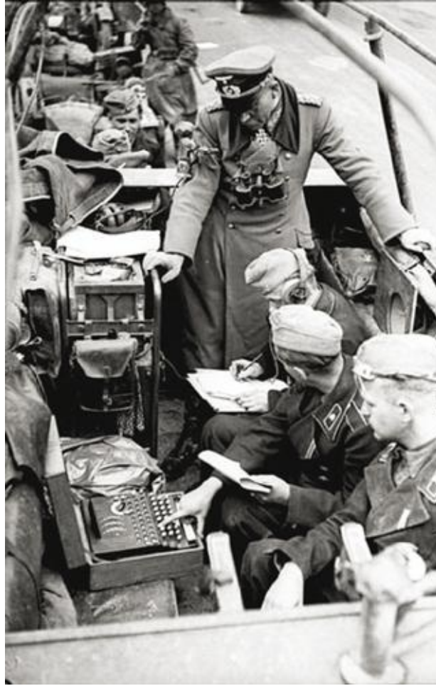
La ligereza de la máquina Enigma, que no llegaba a 12 kilos de peso, hacía muy fácil el traslado y la operatividad de este aparato de cifrado, ya que, sin grandes problemas, podía ser transportada a las zonas de combate. Así se demuestra en esta fotografía hecha por Erich Borchert (mayo-junio de 1940) en la que los agentes codificadores han montado una máquina Enigma en un vehículo semioruga Sd. Kfz. 251 al mando del general Heinz Guderian, jefe del 2.º Grupo Pánzer. Bundesarchiv, Berlín.
